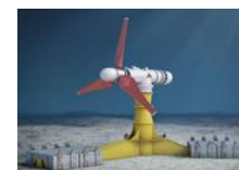
国内初の500kW規模潮流発電機(海底設置型)
